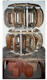
Экспериментально создана конфигурация магнитного поля такая, что его напряжённость нарастает по направлению из центра кривизны силовых линий ( $\beta_{min}$ ), что необходимо для удержания сверхвысокотемпературной (термоядерной) плазмы.
